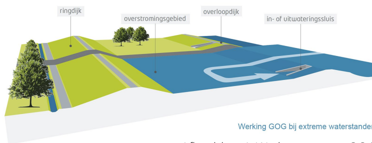
Afbeelding 6: Werking van een GOG
