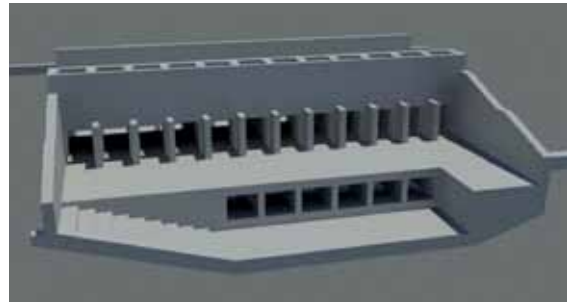
Afbeelding 6.12. De Scheldezijde van de in- en uitwateringsstructuur. Onderaan zijn de 3 uitwateringskokers zichtbaar (elke koker bestaat uit 2 delen), bovenaan de 6 inwateringskokers (die ook uit 2 delen bestaan).
